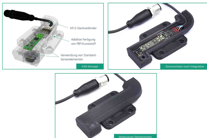
Demonstrator des individualisierten Sensors in den unterschiedlichen Fertigungsstufen: CAD-Konzept (oben links), nach der Integration der elektronischen Komponenten (oben rechts) und als fertiger Demonstrator (unten).
