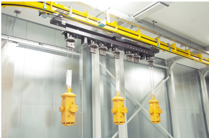
Langlebige, optimal lackierte Bauteile als Ergebnis einer Stückzahl-flexiblen Lackieranlage.
