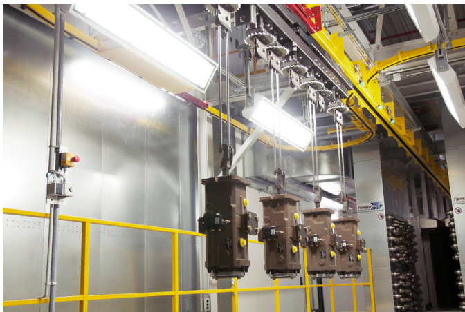
Einführung eines zukunftsfähigen Lackierprozesses bei LHY Powertrain: von der Fördertechnik, über die Lackapplikation bis zur Trocknung. Quelle: LHY Powertrain GmbH & Co. KG
