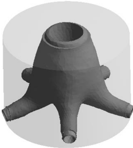
Bild 3: Ergebnis der Topologieoptimierung
